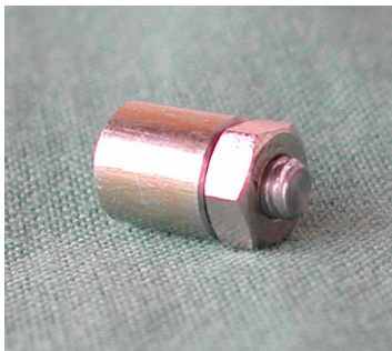
Abb. 6: Einspannhilfe zum Bearbeiten der Madenschrauben auf der Drehmaschine
